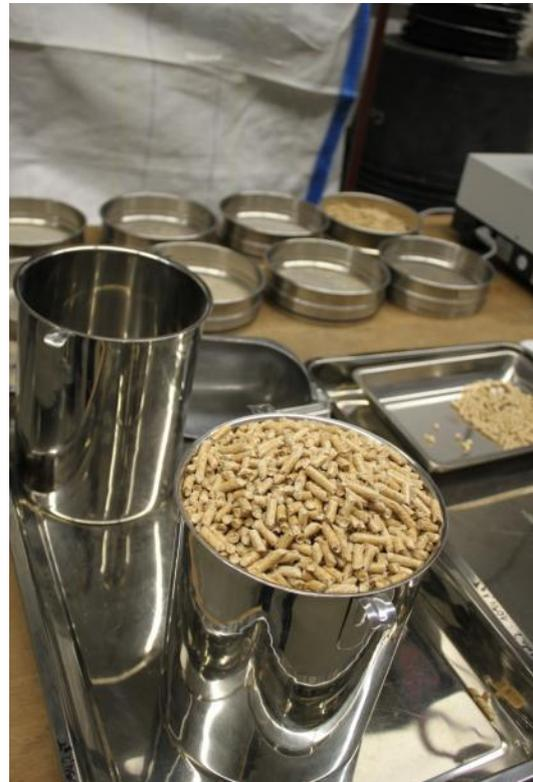
Abb.4: Gerätschaften für die Analyse von Brennstoffeigenschaften (vorne: Behälter für die Schüttdichtebestimmung, hinten: Siebe für die Abtrennung des Feinanteils)
