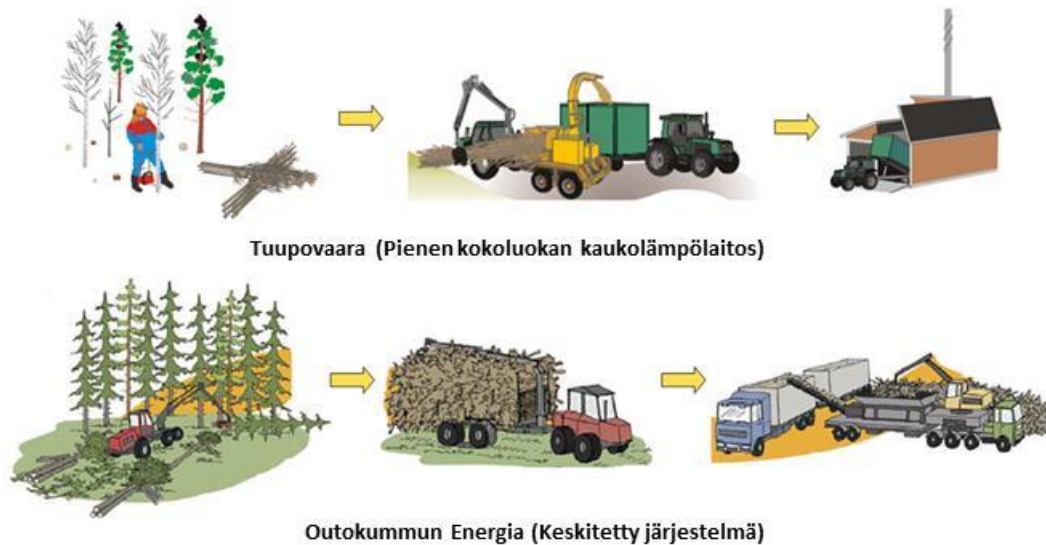
Kuva 3: Esimerkki puuhakkeen tuotantoketjusta Suomessa (Lähde: Pekkanen, 2011)
